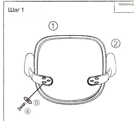
Возьмите 6 винтов и 6 уплотнителей, установите на подлокотники с обеих сторон сиденья и закрепите винты с помощью гаечного ключа.
